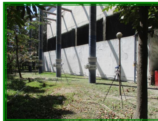
ภาพถ่ายการตรวจวัดระดับเสียงในสถานที่ทำงาน บริเวณอาคาร WHG 6 (Cooling Tower)
